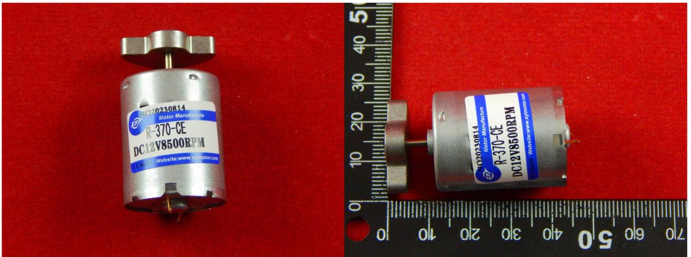
Вибромотор с эксцентриком — это старый тип моторчиков. Суть его работы заключается во вращении эксцентрика со смещенной массой, прикрепленного к валу. Такой дисбаланс создает вибрации, однако так как моторчик жестко прикреплен к какому-либо корпусу, эти вибрации передаются именно на него.
