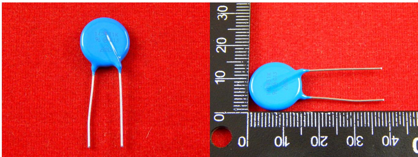
Варистор 14D431K изготавливается из полупроводниковых керамических материалов, состоящих в основном из оксида цинка. Он имеет нелинейное сопротивление, которое изменяется в зависимости от приложенного напряжения. Так же имеет малый размер, большую емкость тока и высокий уровень защиты.
