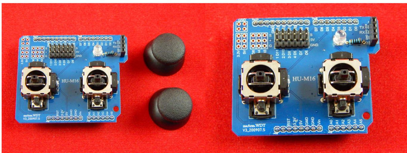
Плата расширения Arduino двойной аналоговой модуль управления на которой располагаться два независимых манипулятора джойстика с полным функционалом стикеров PS2. Плата предназначена для контроллеров Ардуино и используется в построении и управлении движением подвижных роботов. Модуль двойного джойстика может только располагаться поверх платы Arduino Uno и Arduino Mega 2560, Arduino Leonardo.
