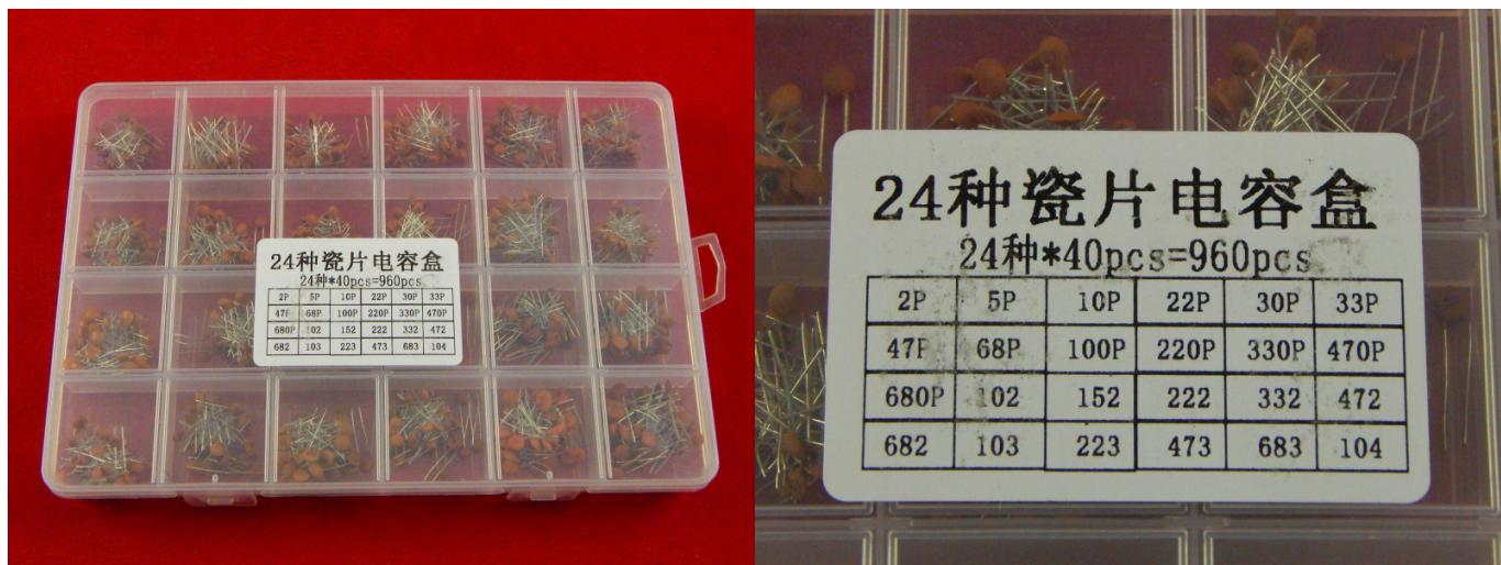
Постоянные конденсаторы, использующие керамический материал в качестве диэлектрика. Любой керамический конденсатор состоит из диэлектрического керамического блока и групп металлизированных электродов. Конденсаторами этого типа постепенно заменяют tantalовые, пленочные и алюминиевые аналоги. Принцип их работы схож, но устойчивость и рабочие характеристики керамики лучше.
