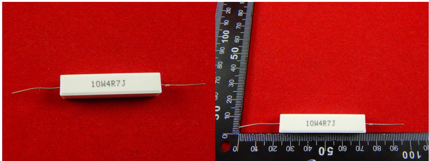
Резистор керамический проволочный – постоянные резисторы, сопротивление которого вы можете выбрать сами, рассеиваемая мощность 10Вт. Предназначены для эксплуатации в цепях постоянного или переменного тока, обеспечивая ограничение силы тока и распределение напряжения. Монолитная керамическая конструкция обладает: огнестойкостью, влагостойкостью и способностью к самозатуханию.
