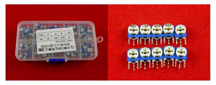
Потенциометры — это регулируемые делители напряжения, которые предназначены для регулирования напряжения при неизменной величине тока, и выполненные по типу переменного резистора.
