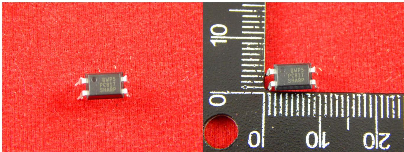
Оптрон — электронный прибор, состоящий из излучателя света и фотоприёмника, связанных оптическим каналом и, как правило, объединённых в общем корпусе.
