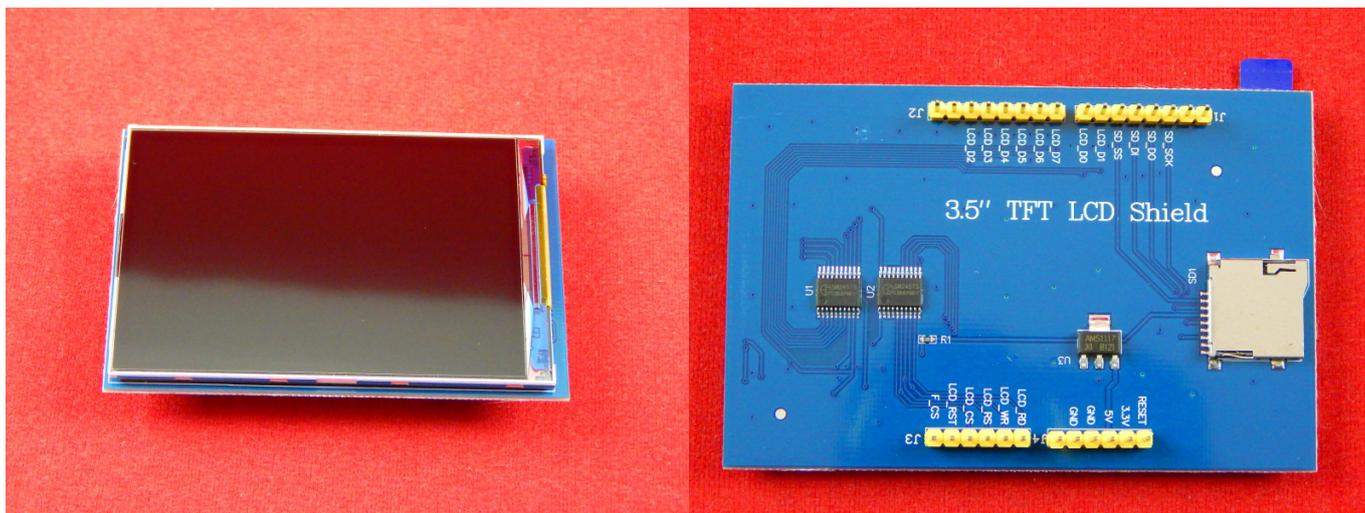
Цветной графический дисплей 3.5 MEGA TFT 480x320 — дисплей, разработанный специально для работы с Arduino MEGA и DUE. Есть слот для SD карты, на которой можно хранить графические данные.
