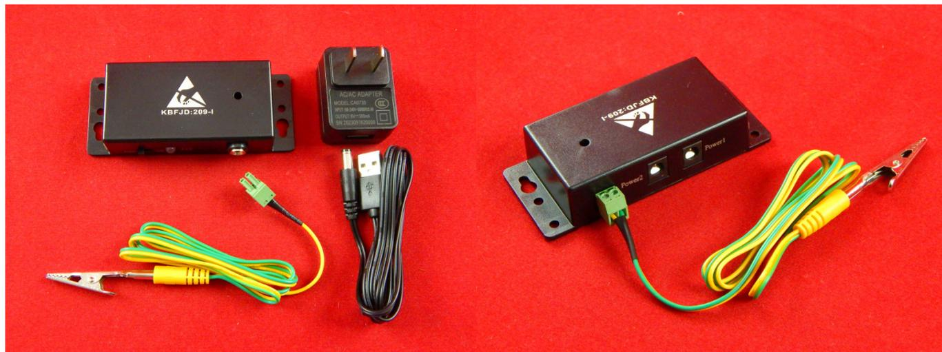
КВФJD:209-1 - компактный, питающийся от сети монитор антистатического браслета, который непрерывно контролирует сопротивление кожи оператора и целостность антистатического браслета. Прибор работает с одноконтурными антистатическими браслетами и поддерживает последовательное подключение питания.
