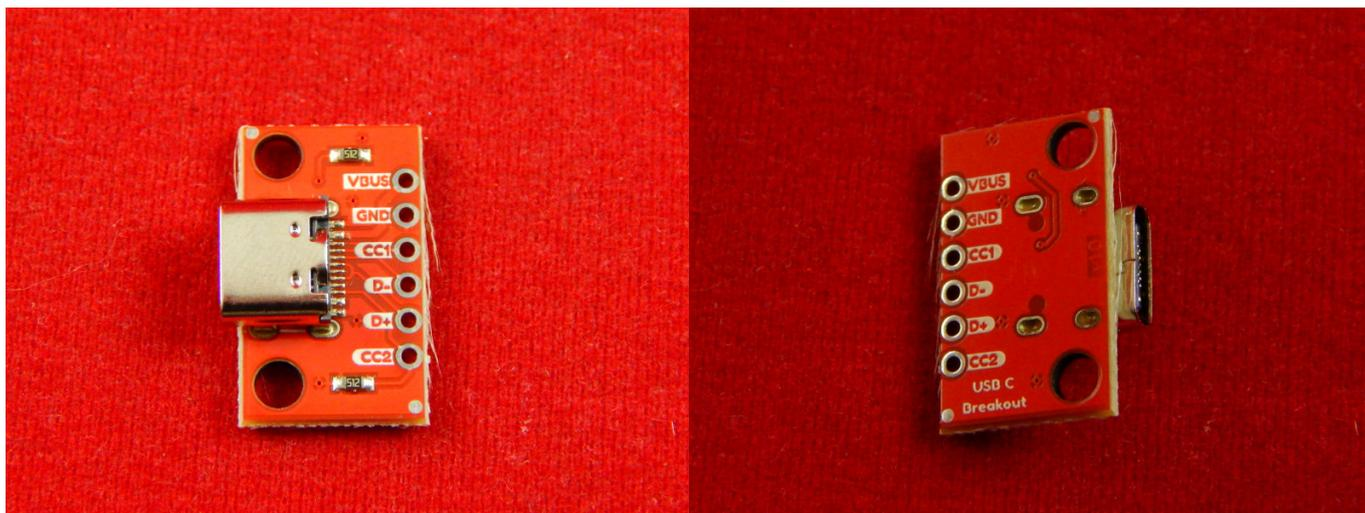
Разъем USB Type-C — спецификация USB для универсального компактного двухстороннего 24-контактного разъёма для USB-устройств и USB-кабелей. Для удобства уже припаянный на плату.
