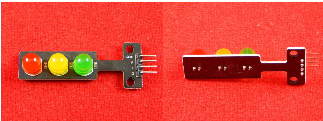
Данный модуль имеет четыре контакта, что позволяет управлять каждым светодиодом отдельно.
