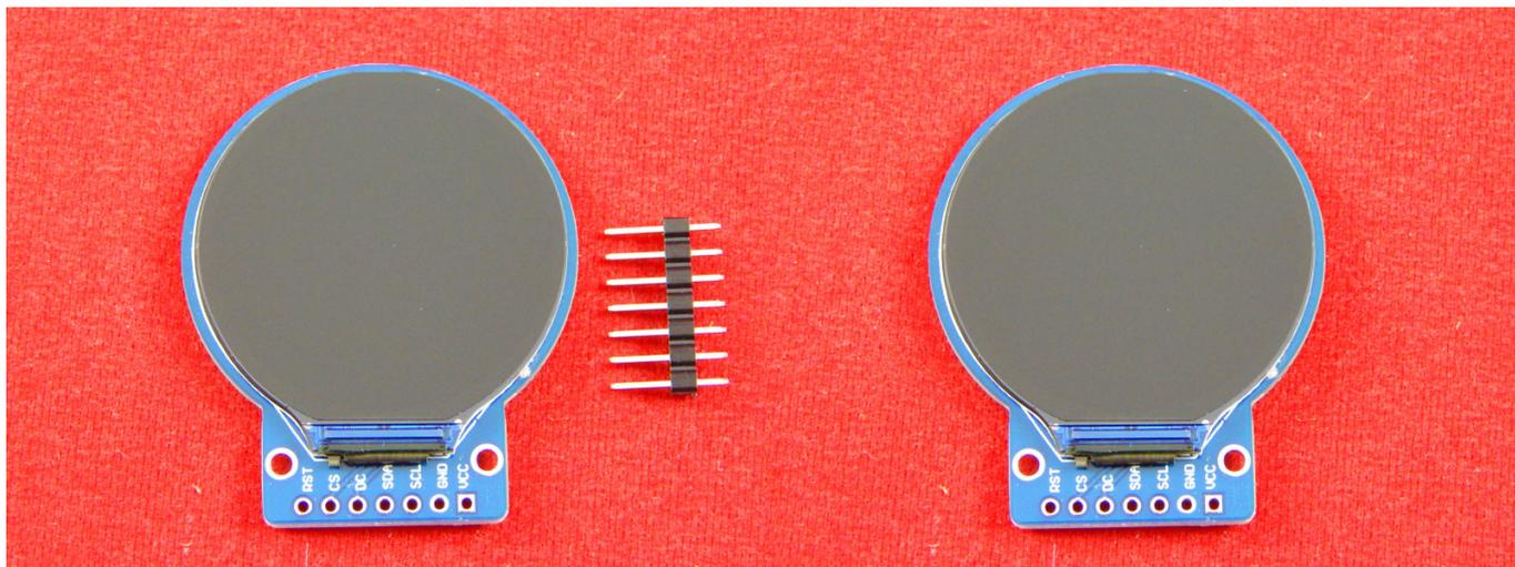
Круглый дисплей с IPS матрицей, разрешением 240x240 пикселей, построен на базе драйвера GC9A01 может использоваться с платформами Raspberry Pi/Jetson Nano/Arduino/STM32, поддерживающими интерфейс SPI. Диаметр видимой области составляет 32.4 мм.
