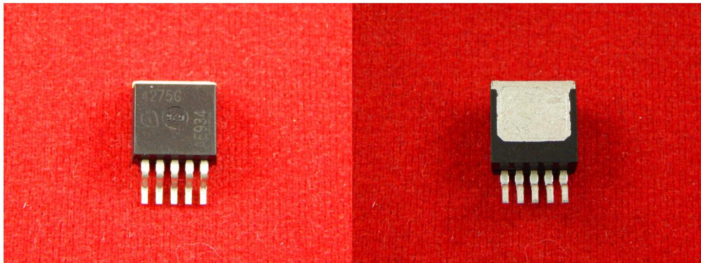
Стабилизатор TLE4275G в корпусе TO-263, используется для ремонта и восстановления в поврежденных автомобильных блоках управления двигателем.
