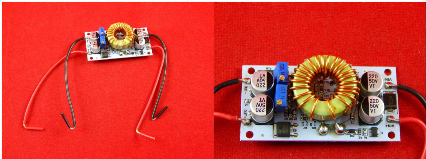
Повышающий DC/DC преобразователь 8.5/48В - 10/50В, 8А.
