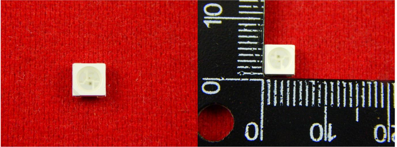
WS2815b адресный светодиод полноцветный с белым верхом. Корпус SMD5050 Адресные светодиоды представляют из себя сборку светодиодных кристаллов и схему управления с ШИМ-контроллерами каждого канала и адресной шины I2C. Не стоит пугаться такой системы, управлять такими светиками на самом деле довольно просто.
