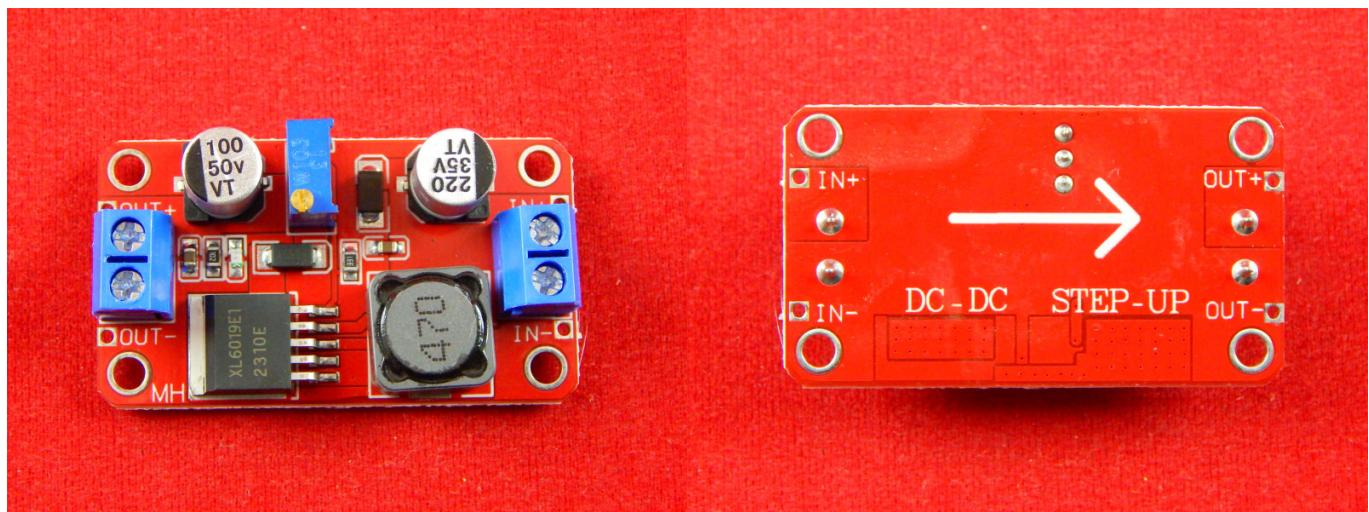
Недорогой и компактный модуль импульсного повышающего преобразователя напряжения постоянного тока (DC-DC). Разработан на основе регулятора XL6019. Улучшенная версия регуляторов на основе LM2577. В плату преобразователя встроена защита от перегрева, обратного подключения и перегрузок по току.
