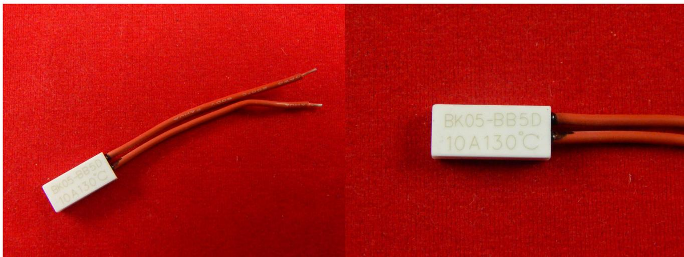
Термостат биметаллический нормально замкнутый с температурой срабатывания +130 градусов Цельсия. Используется в бытовой технике для экстренного отключения при перегреве. При остывании возвращается в первоначальное состояние.
