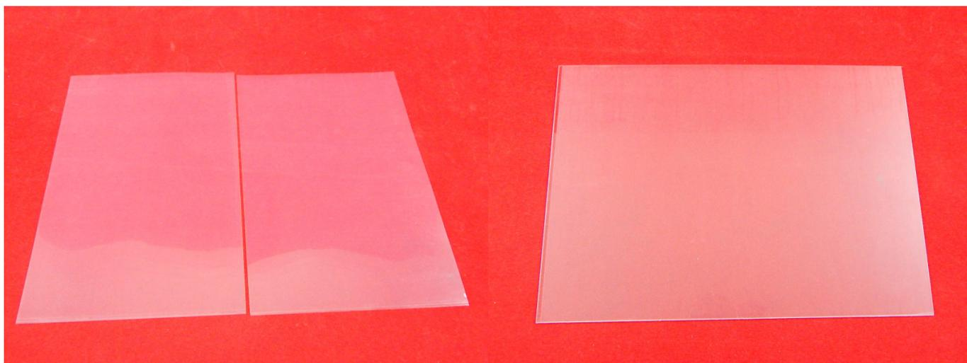
FEP-пленки используются в фотополимерных принтерах. Они выступают барьером между смолой и дисплеем для засветки слоев. Пленка надежно закрепляется в рамке и хорошо пропускает любые виды излучения. Со временем пленка может мутнеть, что влияет на качество печати. Поэтому следует регулярно следить за ее состоянием и вовремя заменять старую пленку на новую.
