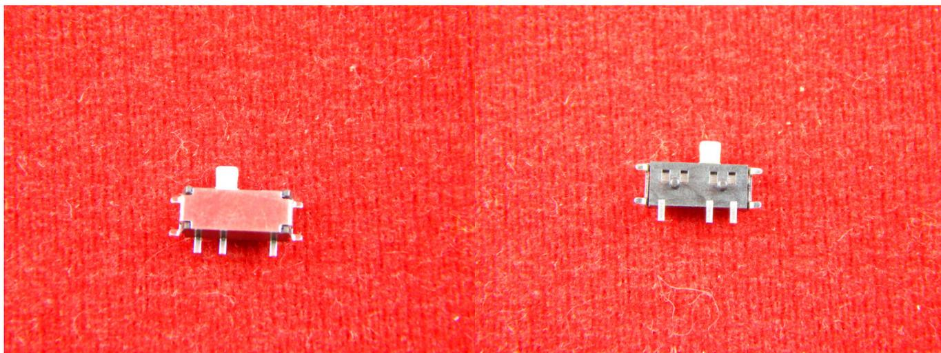
Микропереключатели – малогабаритные устройства, которые коммутируют цепи переменного и постоянного тока в электронных и радиотехнических устройствах. Несмотря на небольшие массогабаритные показатели, по своим техническим характеристикам микропереключатели не уступают другим видам переключателей.
