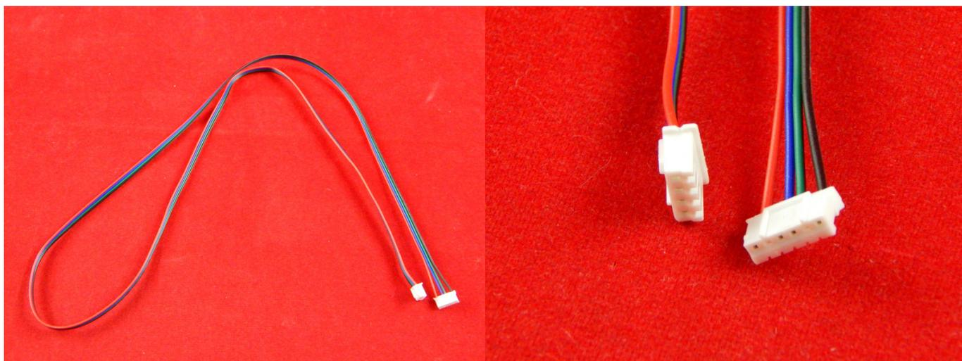
Четырех-контактный кабель с разъемами ХН2.54-4Р на РН2.0-6Р. Используется для подключения некоторых шаговых двигателей к плате управления.
