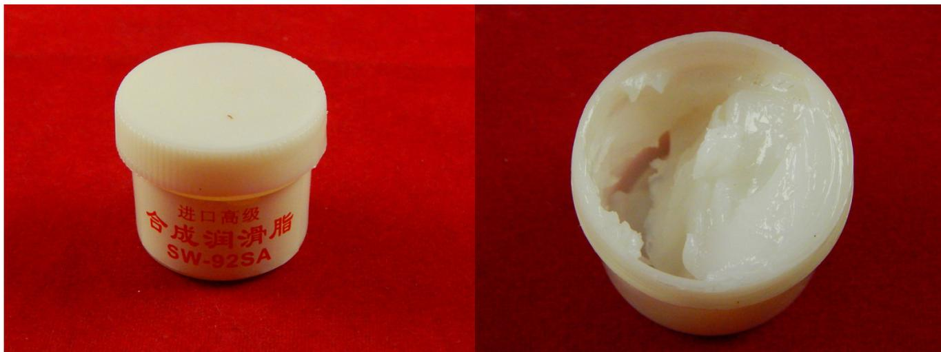
Синтетическая литиевая смазка SW-92SA предназначена для смазки подшипников, шестеренок, а так же для снижения шума работы клавиатуры, свитчей и прочих металлических и пластмассовых узлов и механизмов. Смазка SW-92SA является высокотемпературной от -20°C до +150°C. Совместима с пластиком и резиной.
