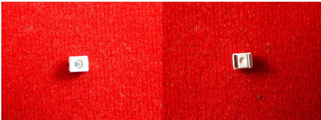
Светодиод - полупроводниковый прибор с электронно-дырочным переходом, создающий оптическое излучение при пропускании через него электрического тока в прямом направлении.
