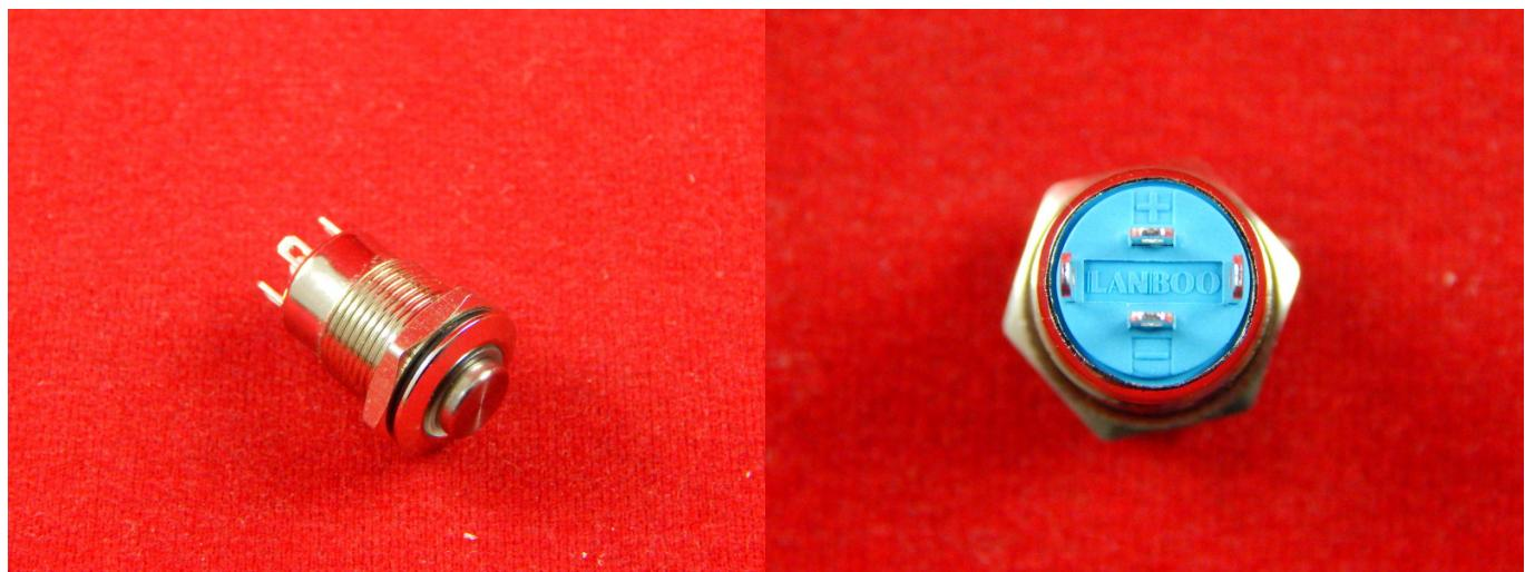
Кнопка с подсветкой – это коммутационное устройство, которое отличается от обычных кнопок наличием светодиодов или неоновых ламп. Светодиоды в данной кнопке, синего цвета. Кнопка с подсветкой может устанавливаться как на панели, так и на печатные платы. Кнопка с подсветкой используются для ручного управления оборудованием или механизмами в различных системах.
