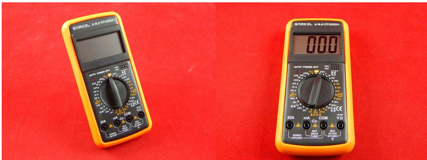
Мультиметр — комбинированный электроизмерительный прибор, объединяющий в себе несколько функций. В минимальном наборе включает функции вольтметра, амперметра и омметра. Иногда выполняется мультиметр в виде токоизмерительных клещей. Существуют цифровые и аналоговые мультиметры.
