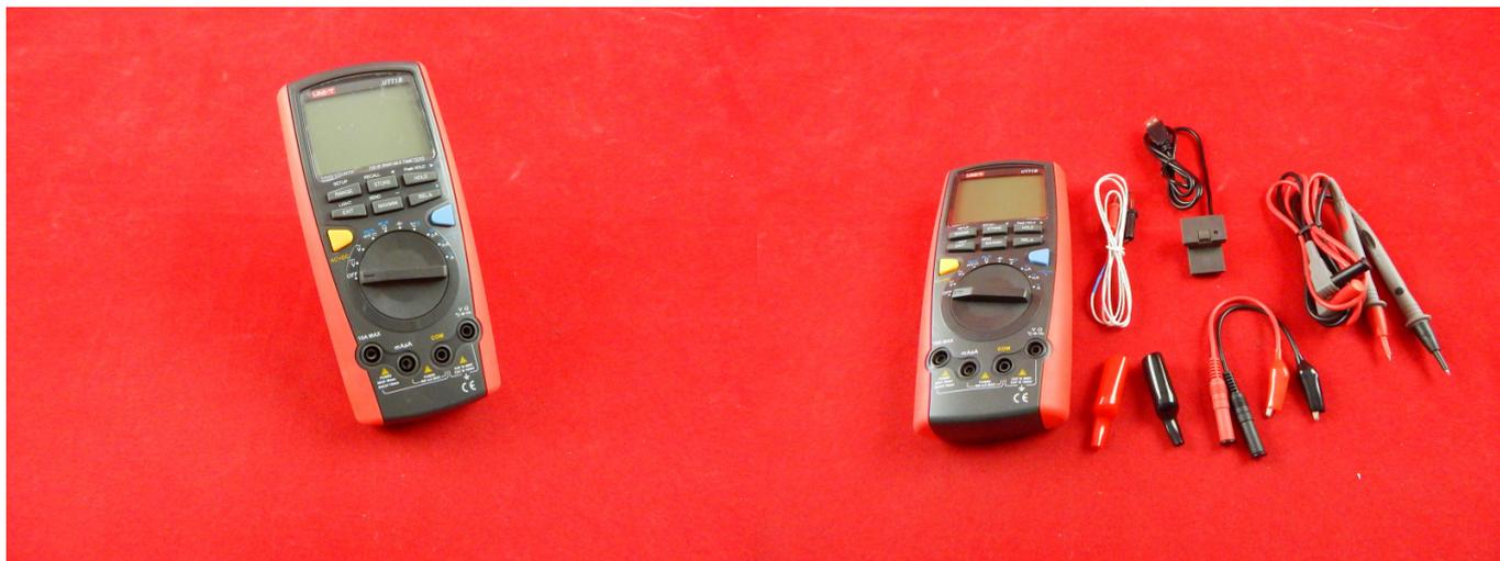
Мультиметр – это универсальный прибор для измерений. Измерений напряжения, тока, сопротивления, а так же проверки провода на обрыв. Для каждого из этих измерений можно использовать специальные измерительные инструменты, такие как: омметр, амперметр, вольтметр.
