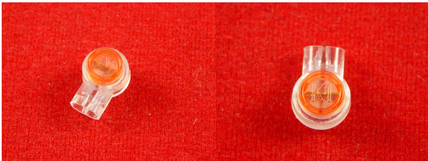
Соединитель UY2 предназначен для сращивания жил кабелей типа ТП диаметром от 0.4 до 0.7 мм и любым типом изоляции до 2.08 мм. Соединитель заполнен гидрофобным наполнителем, предотвращающим проникновение влаги в контакты. Не требует зачистки изоляции, ускоряет и упрощает процесс сращивания пар.
