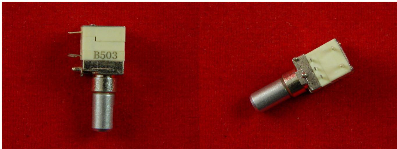
Потенциометр — это обобщённое название переменного резистора, включенного как делитель электрического напряжения. Под потенциометрами, как правило, подразумевают резисторы с подвижным отводным контактом.
