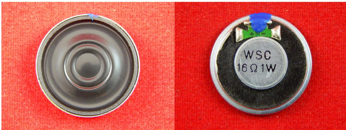
Динамик – устройство, преобразующее электрические сигналы в звуковые путём перемещения катушки с током в поле постоянного магнита с последующим преобразованием механических колебаний в колебания окружающего воздуха с помощью диффузора.
