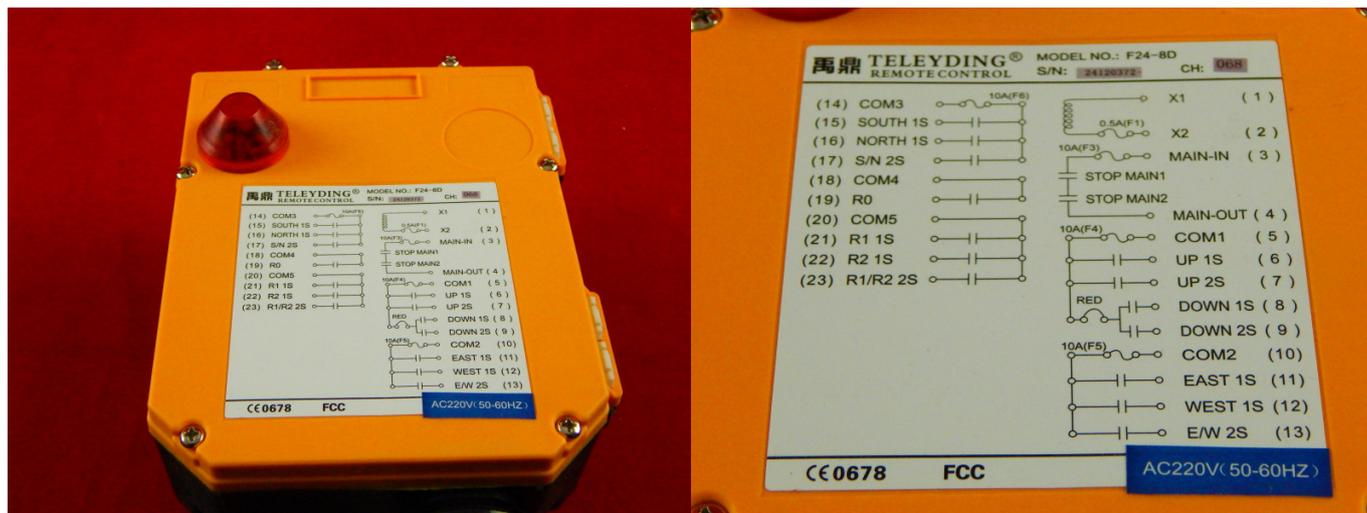
Радиоуправление F24-8D это 8 кнопочный пульт с 2 скоростями управления. Данная серия предназначена для дистанционного управления любых типов кранов и различными промышленными механизмами.
