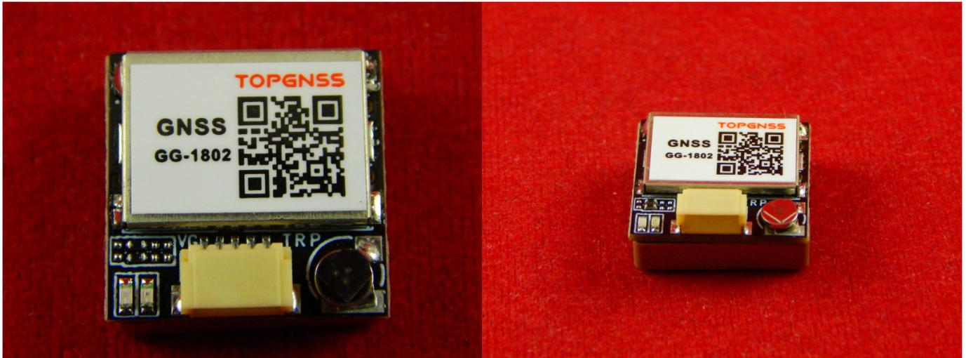
GG-1802 - это малогабаритный приемник GPS, GLONASS, BeiDou, Galileo и QZSS .
