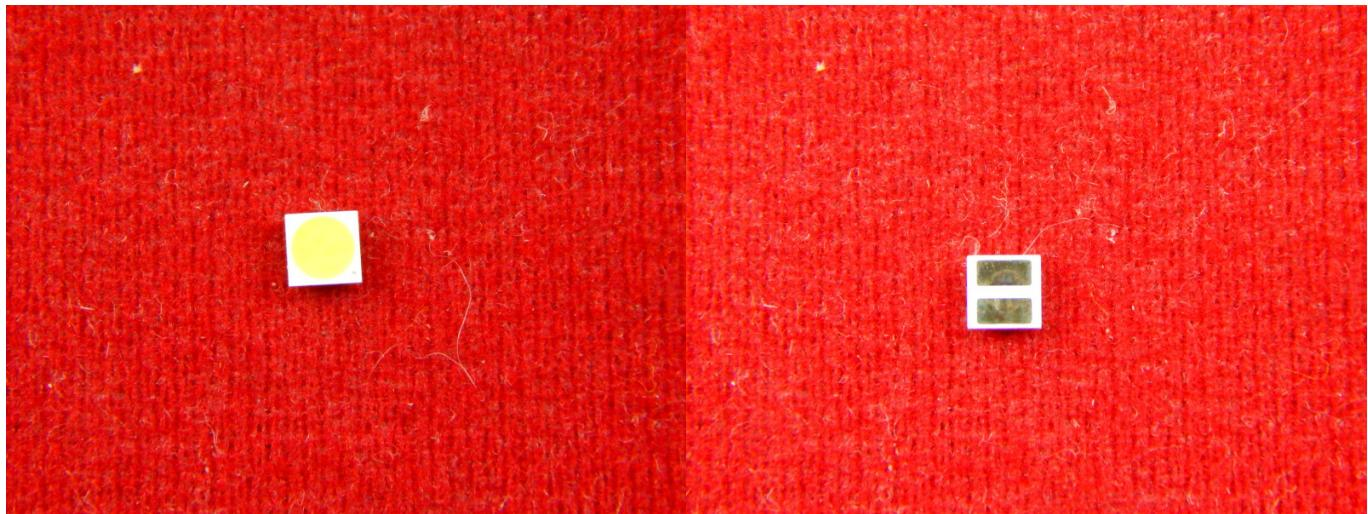
Светодиод — это полупроводниковый прибор, преобразующий электрический ток непосредственно в световое излучение. Светодиод для поверхностного монтажа (3030 SMD LED).
