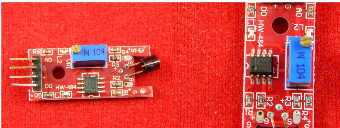
Модуль KY-036 для Ардуино является цифроаналоговым датчиком прикосновения. Он также работает, если прикоснуться к чувствительному контакту металлическим предметом. Поэтому его так же называют датчиком металла.
