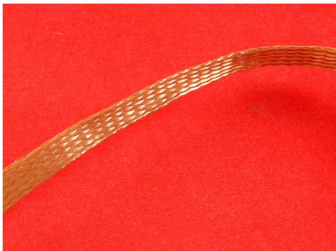
Плетенка ПМЛ может использоваться в широком спектре технических и бытовых работ, например для заземления различных приборов и токоведущих частей оборудования. Так же применяется для экранирования монтажных проводов, кабелей, жгутов, что защищает и предотвращает от электромагнитных наводок и излучений.
