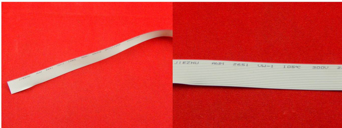
Луженый, отожженный, многожильный или сплошной медный проводник с верхним покрытием. Номинальная температура: 105°C. Номинальное напряжение: 300 В. Проходит испытание на вертикальное пламя UL VW-1 и CSA FT1. Для использования во внутренней проводке приборов.
