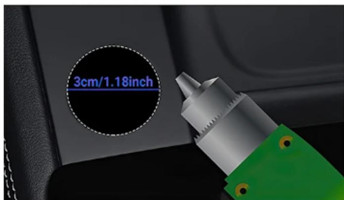
Просверлить отверстие  $\varnothing 3$  мм
