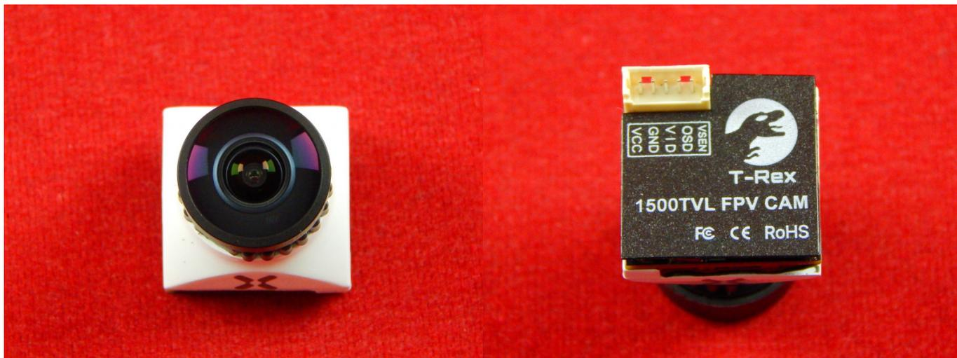
FPV в сфере дронов или беспилотного хобби — это трансляция видео в режиме реального времени с камеры дрона на монитор, очки или шлем пилота. Другими словами эта технология позволяет видеть то, что «видит» дрон в момент полета. Для осуществления такого полёта на дрон устанавливается камера, видеопередатчик и антенна.
