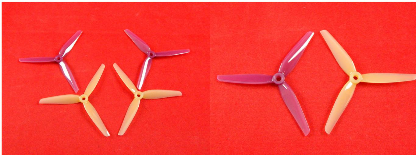
Пропеллер - лопастной движитель, создающий при вращении тягу за счёт отбрасывания воздуха назад с некоторой дополнительной скоростью, приводимый во вращение двигателем и преобразующий крутящий момент двигателя в силу тяги.
