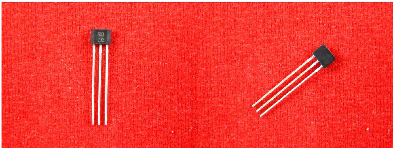
Датчик эффекта Холла - измерительный преобразователь для измерения величины магнитного поля. Принцип работы датчика основан на эффекте Холла, и его исходное напряжение прямо пропорционально напряжённости магнитного поля.
