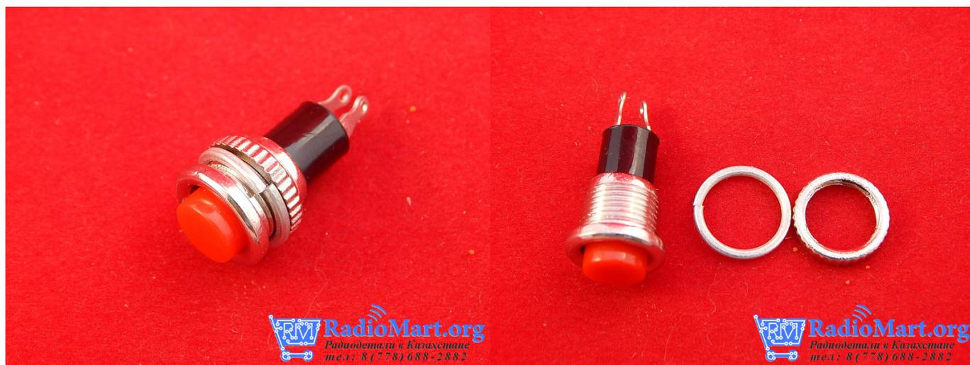
Кнопка DS-316 OFF-(ON), 250В, 0.5А, без фиксации, гайка снизу, красная
