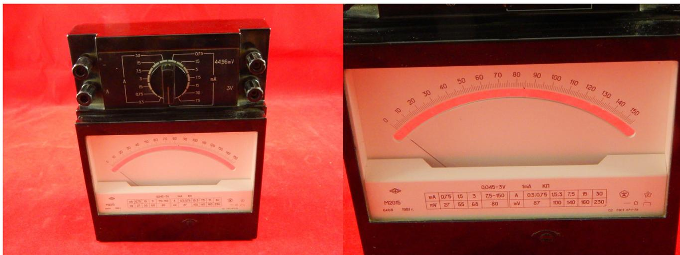
Вольтамперметр М2015 предназначен для измерения тока и напряжения в цепях постоянного тока. Вольтамперметр представляет собой переносный многодиапазонный прибор магнитоэлектрической системы.
