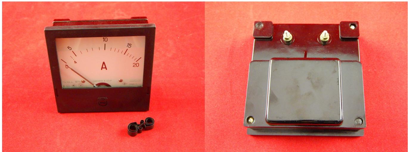
Стрелочный амперметр Э365-1 - это аналоговый измерительный прибор. Предназначен для измерения переменного тока. Класс точности измерений Э350-1 составляет 1.5.
