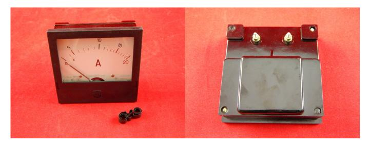
Стрелочный амперметр ЭЗ65-1 - это аналоговый измерительный прибор. Предназначен для измерения переменного тока. Класс точности измерений ЭЗ50-1 составляет 1.5.
