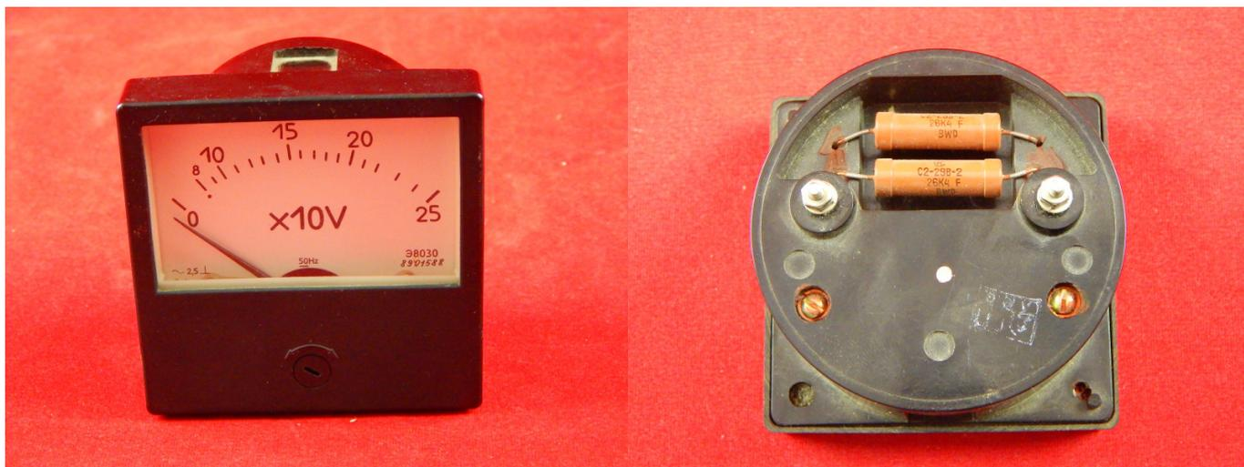
Вольтметр Э8030 предназначен для измерения напряжения в сетях переменного тока на передвижных и стационарных объектах.
