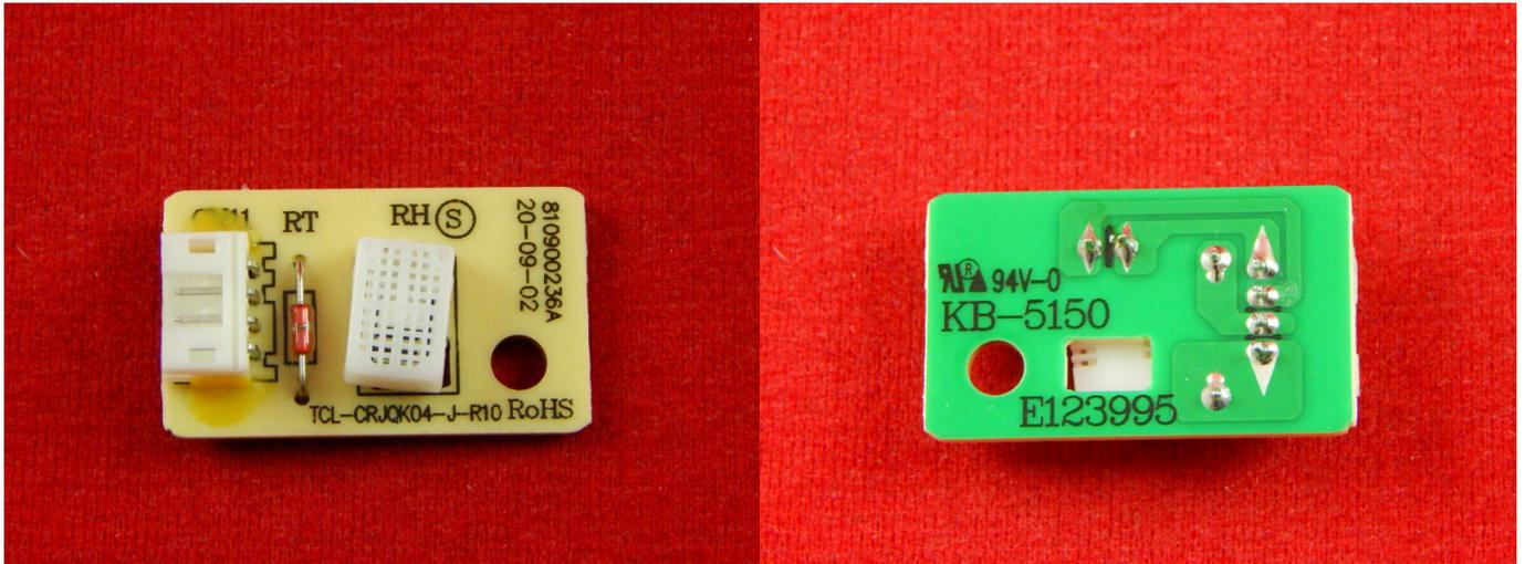
Датчики влажности - это устройства, преобразующие показатели относительной влажности воздуха в определённые величины.
