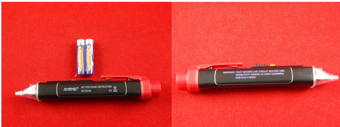
Бесконтактный индикатор напряжения - прибор, с использованием которого есть возможность определять контакты под напряжением, расположенные в изолированных проводах и кабелях, а также в проводке под штукатуркой.
