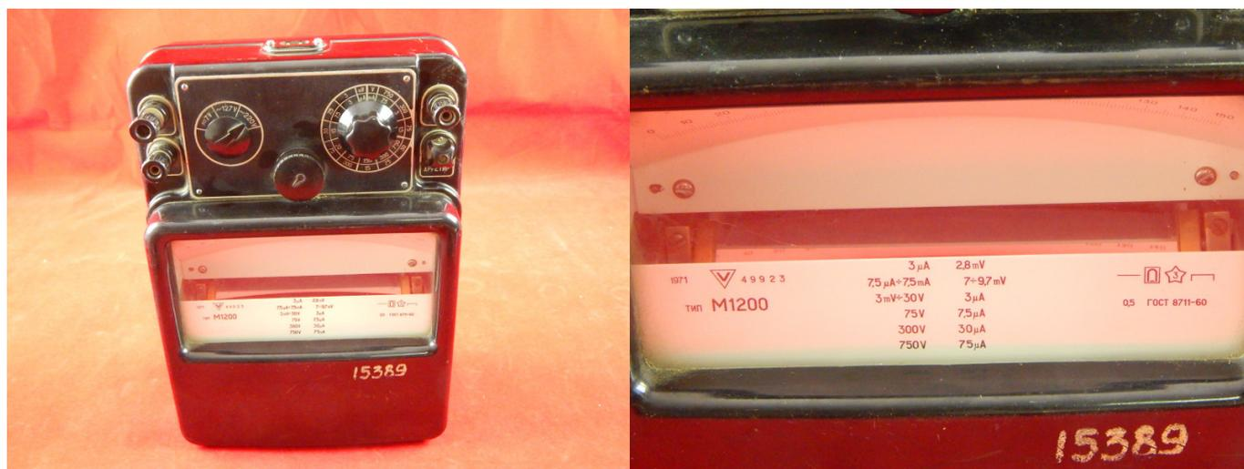
М1200 милливольтмикроамперметр служит для измерения тока и напряжения в цепях постоянного тока.
