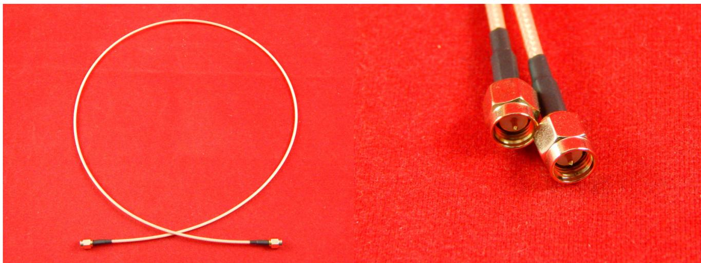
RG316 SMA/SMA (папа-папа) - это кабель с обжатыми разъемами SMA, установленными с обеих сторон и имеющие термоусадки которые защищают место стыка кабеля и разъема от попадания влаги. Кабель предназначен для подключения ВЧ аппаратуры радиосвязи, сотовой связи, антенн, роутеров и модемов различного применения.
