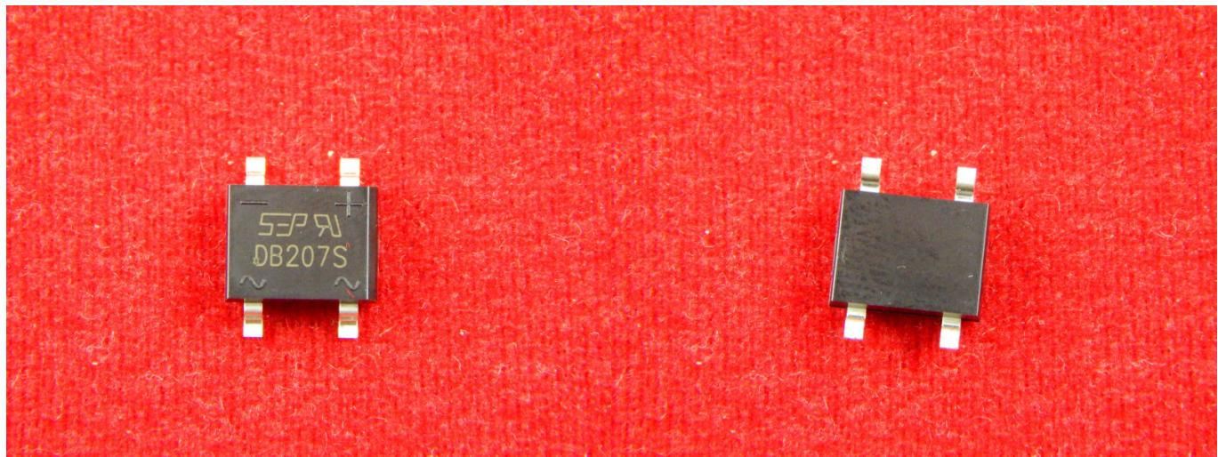
DB207S - диодный мост 2А 1000В в пластиковом корпусе с выводами для поверхностного SMD монтажа на печатную плату.
