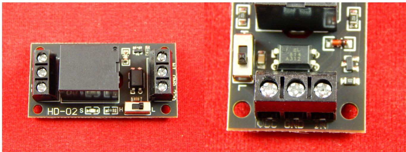
Модули электромеханических реле остаются самыми востребованными и часто незаменимыми компонентами подавляющего большинства разрабатываемых проектов, алгоритмы которых основываются на выполнении автоматизированного взаимодействия между несколькими электрическими цепями при наступлении условных событий, заранее предопределённых целями каждого отдельно взятого проекта.
