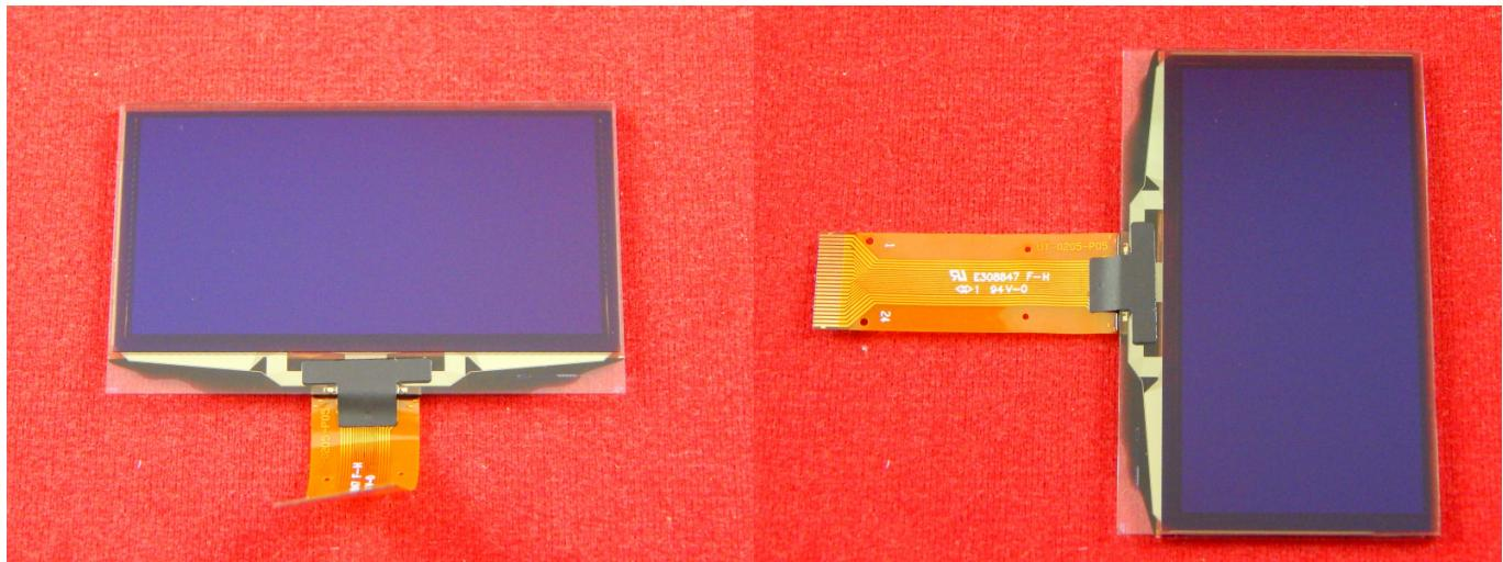
Модуль с монохромным OLED-дисплеем имеет диагональ 2.42 дюйма с разрешением 128x64 пикселей. Матрица OLED-дисплея состоит из пикселей одного цвета (белых, желтых, зелёных, или синих) под управлением встроенной однокристальной микросхемы драйвера SSD1309.
