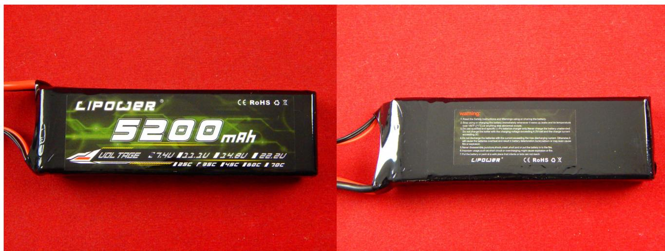
Литий-полимерный аккумулятор — это усовершенствованная конструкция литий-ионного аккумулятора. В качестве электролита используется полимерный материал. Данный аккумулятор используется в радиоуправляемых моделях.
